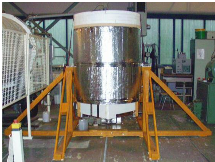
Abbildung 6 750 l -Schüttstichtreaktor im Betriebszustand
